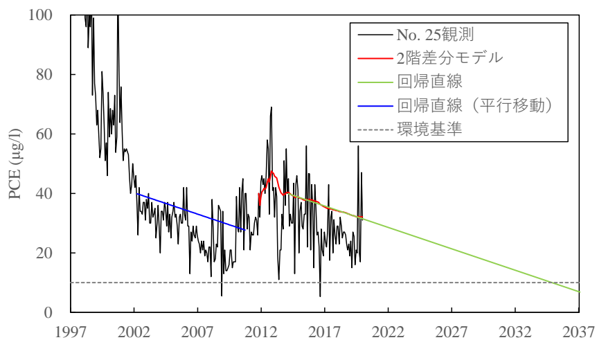
図 4-13 監視基準井戸（No. 25）における PCE 濃度の変化と回帰直線
