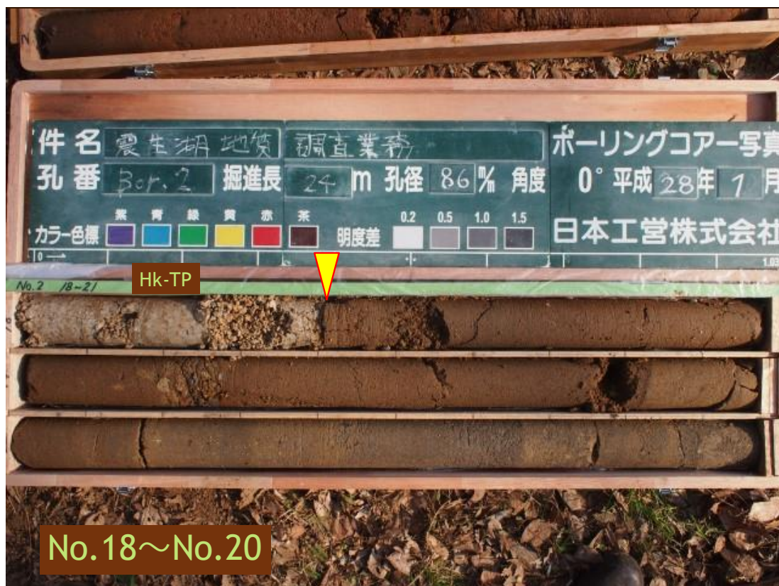
図 2 ボーリング資料 △印が推定滑り面
